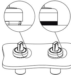
L'anneau façonné peut être utilisé s'il n'y a pas de porte-plaquettes ou d'autres dispositifs, il empêche le dépôt de saleté ou d'autres résidus entre le potentiomètre et le panneau ou le boîtier.
